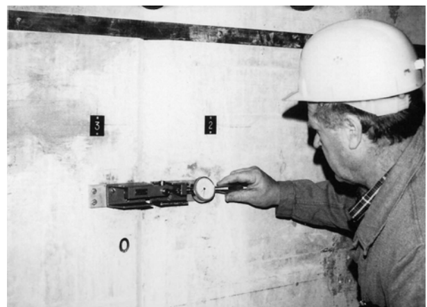
Figur 2.20-3: Fugenmessgerät für drei Messrichtungen mit analoger Messuhr
