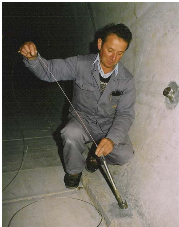
Figur 1.13-1: Normalthermometer im Bohrloch
