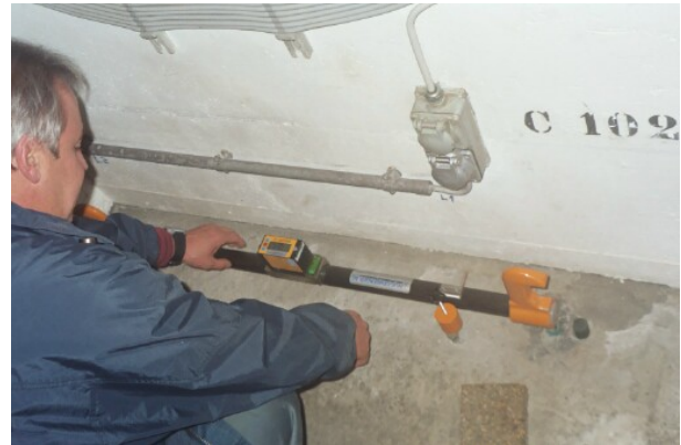
Figur 2.19-1: Klinometermessung mit digitaler Ablesung
