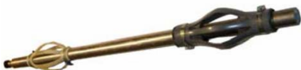
Figur 4.03-1: Bohrlochkamera mit 42 mm Durchmesser
