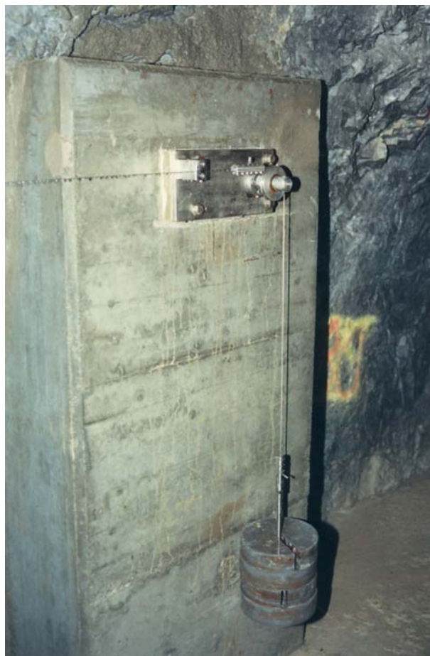
Figur 2.10-5: Alignementsfixpunkt mit Gewicht, welches den Draht spannt.
