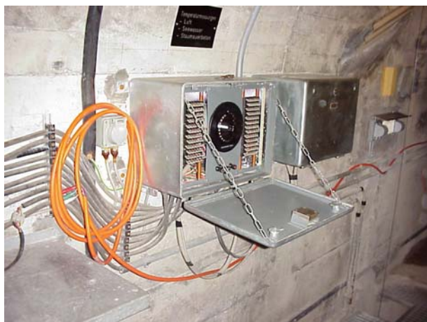
Figur 1.14-1: Sammelmessstelle für Betontemperaturen
