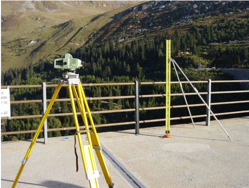
Figur 2.05-2: Digitalnivellier mit 2 m Strichcode Nivellierlatte
