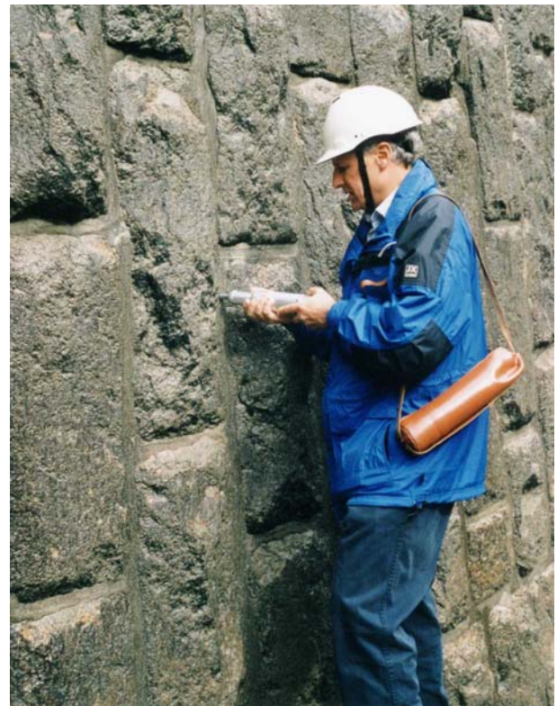
Figur 4.04-2: Anwendung des Schmidt-Hammers auf einer Staumaueroberfläche
