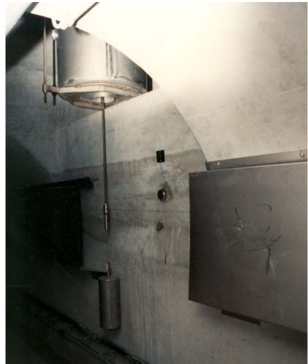
Figur 2.10-2: Zwischenaufhängung des Drahtes mit einem Schwimmer
