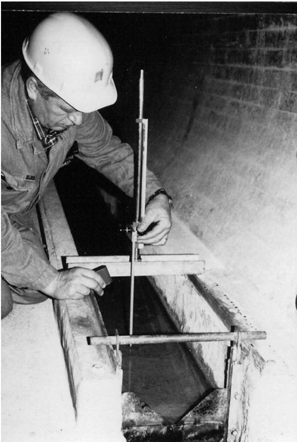
Figur 3.02-1: Messüberfall mit Stechpegel
