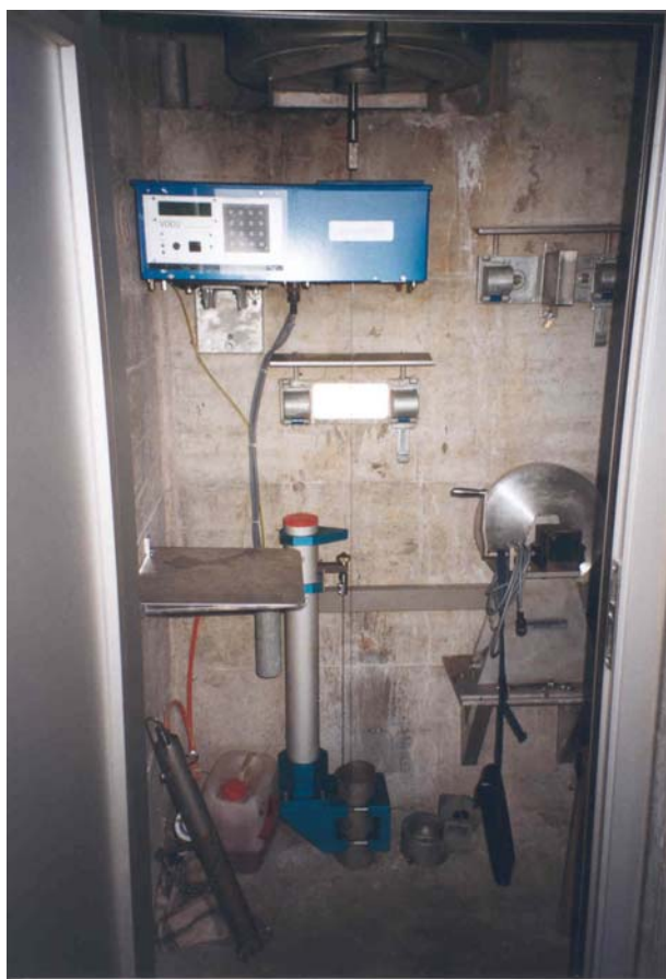
Figur 2.09-1: Schwimm- lot mit Gleitanker und automati- scher Registrierung
