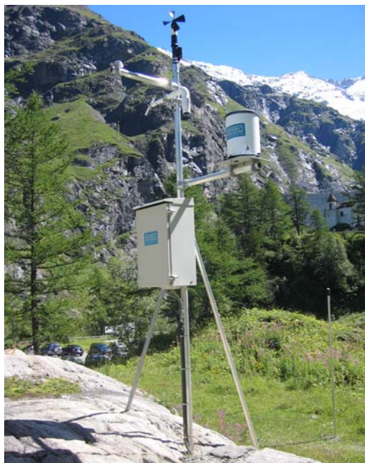
Figur 1.6-1: Pluviograph mit Wippenprinzip
