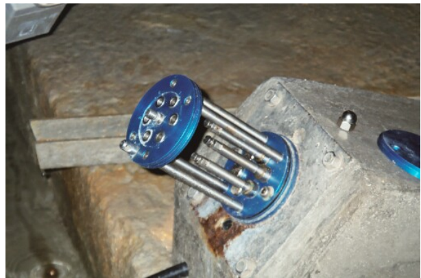
Figur 2.14-4: offener Messkopf mit drei Messstangen
