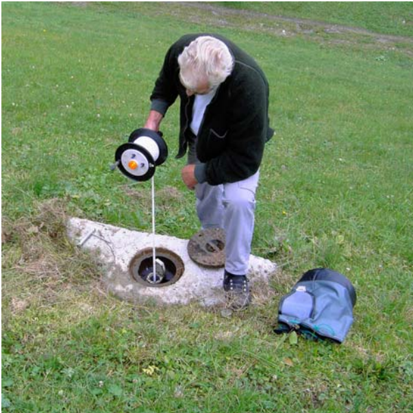
Figur 3.05-2: Wasserstandsmessung im Piezometerrohr mit Kabellichtlot
