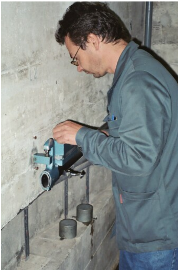
Figur 2.19-2: Klinometermessung mit mechanischer Justierung
