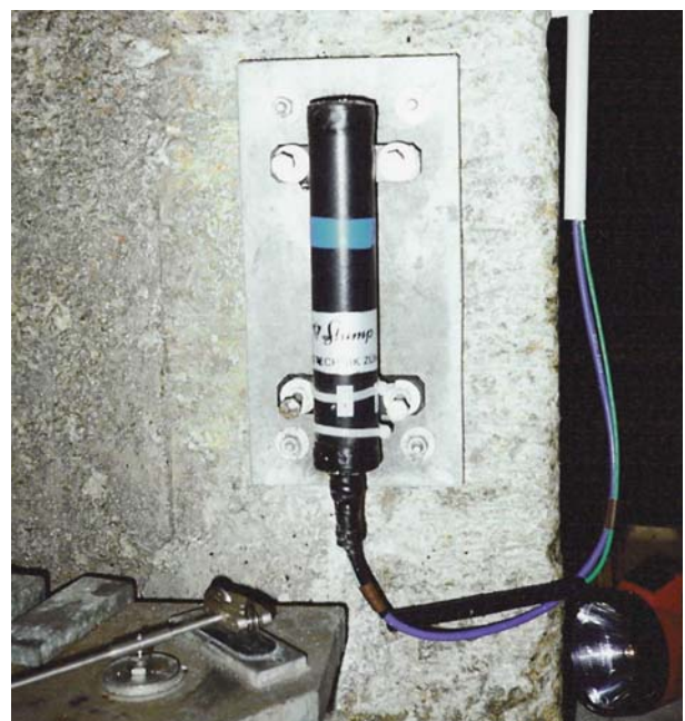
Figur 2.19-4: Elektrisches Tiltmeter für die Messung der Neigung in zwei Richtungen
