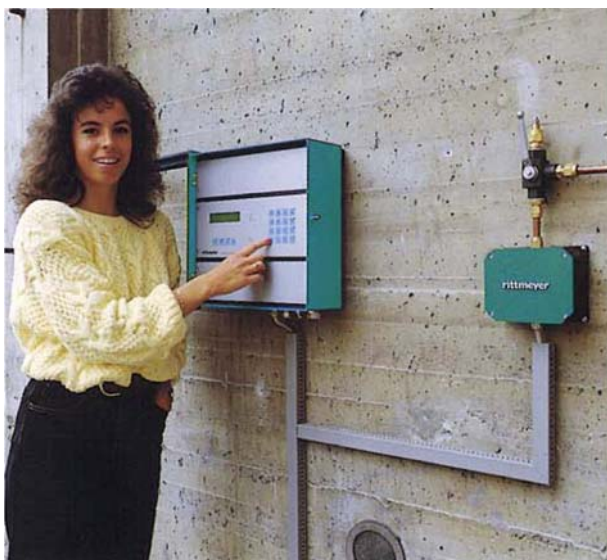
Figur 1.01-1: Quarz-Druckwaage (Quelle: Rittmeyer AG, Zug)
