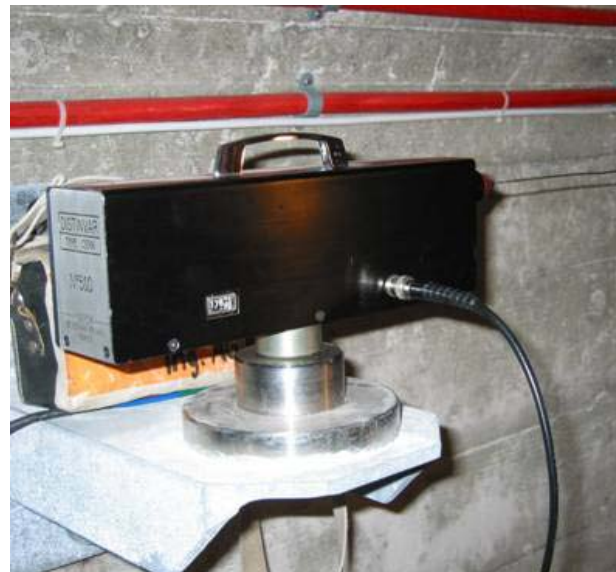
Figur 2.13-2: Distinvar auf einer Konsole zur Messung von Polygonstrecken im Kontrollgang einer Staumauer
