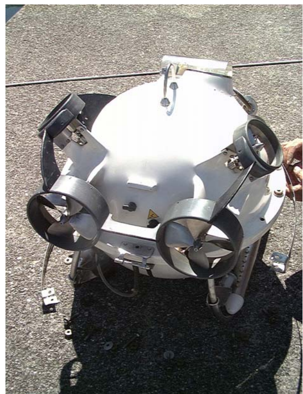
Figur 4.02-1: Vorder- und Hinterseite einer Unterwasserrobotkamera
