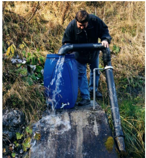
Figur 3.01-2: Volumetrische Sickerwassermessung mit schwenkbarem Rohr für grosse Abflüsse
