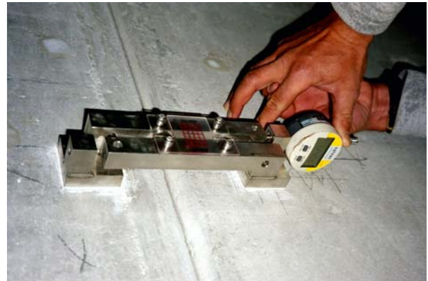
Figur 2.20-2: Fugenmessgerät mit drei Richtungen die je auf beiden Seiten der Fuge gemessen werden können
